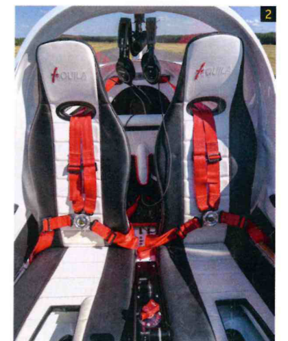
1 Glas muss sein Mit Uhrenladen gibt es die A212 gar nicht. Aquila ist der erste Hersteller, der das Garmin G500 TXi ab Werk verbaut. Auch ein G5 ist als Backup-Horizont integriert 2 Sportlich Die ergonomisch geformten Sitze sind auch bei längeren Flügen bequem. Vierpunkt-Gurte geben den Insassen guten Halt
