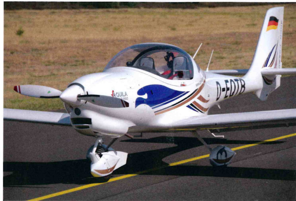
Bullig Die Cowling für den Rotax 914 braucht mehr Lufteinlässe und zusätzlichen Platz. Das Ergebnis ist optisch sehr gut gelungen
