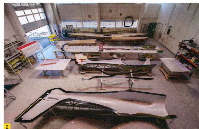
1 Balanciert In das Horn oben am Seitenruder werden als Ausgleichsgewicht Bleikugeln (im Becher unten) einlaminiert 2 Made in Germany Auch die Kunststoffteile entstehen in Schönhagen – der Rumpf in zwei Hälften, der Flügel mit durchgehendem Hauptholm 2 Kleine Stückzahl Derzeit fertigt Aquila pro Monat etwa zwei Flugzeuge
