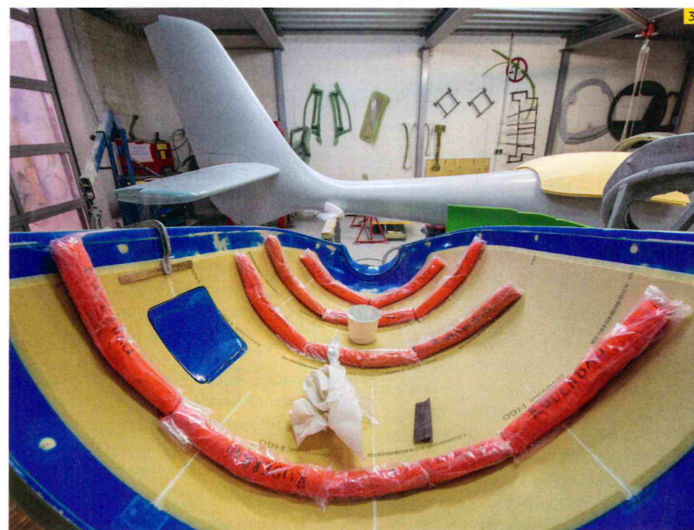
1 Balanciert In das Horn oben am Seitenruder werden als Ausgleichsgewicht Bleikugeln (im Becher unten) einlaminiert 2 Made in Germany Auch die Kunststoffteile entstehen in Schönhagen – der Rumpf in zwei Hälften, der Flügel mit durchgehendem Hauptholm 2 Kleine Stückzahl Derzeit fertigt Aquila pro Monat etwa zwei Flugzeuge
