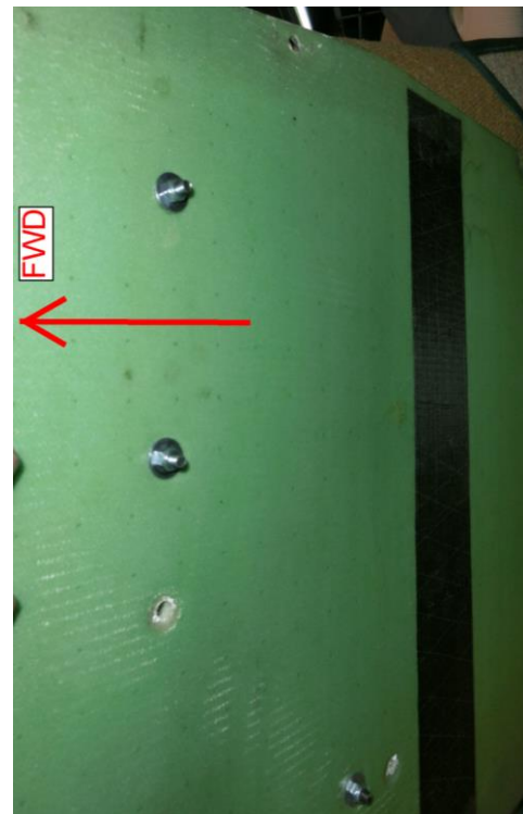
Abb. 2: Befestigungsbohrungen Umrüstung HAL 1.0 auf A344T
