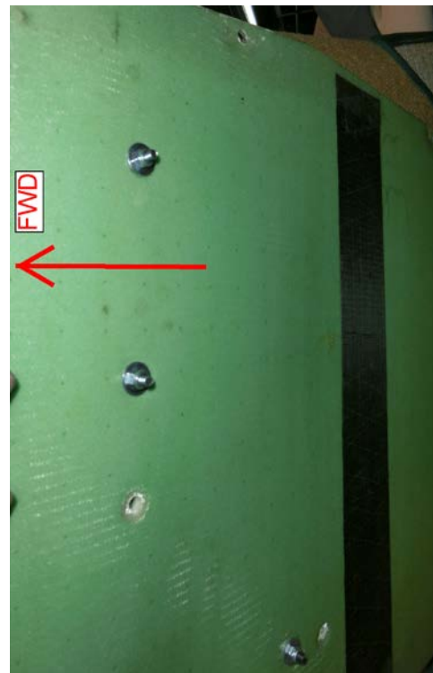
Abb. 2: Befestigungsbohrungen Umrüstung HAL1.0 auf A344T
